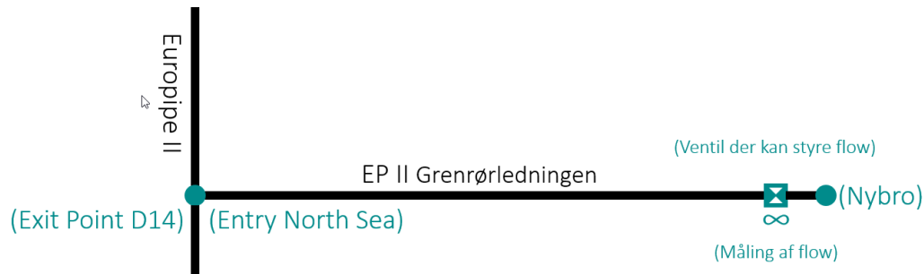
Figur 3. Skitse af EP II Grenrørledningen og den sammenhæng den indgår i
